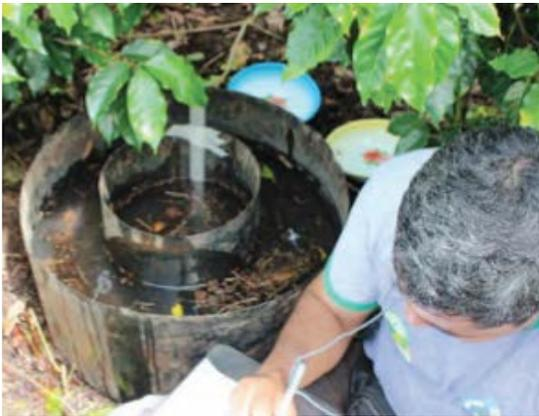
Consiste en hacer uso de dos cilindros concéntricos: un cilindro interior, con un diámetro de 30 cm y un cilindro exterior, con un diámetro de 60 cm (figura 14).
