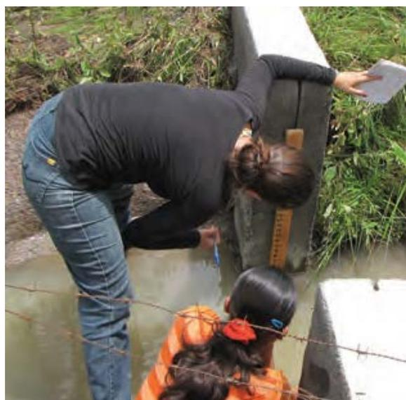
**Figura 16. Aforo de la quebrada Marroquín en la microcuenca Marroquín con un molinete tipo pigmeo.**
