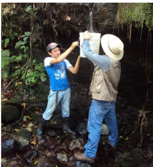
**Figura 17. Demostración y práctica sobre cómo realizar un aforo.**
